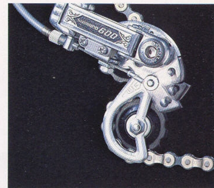
Hatch-Plate Mechanism (Shimano-600EX Rear Derailleur).
