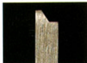
Chamfered Sprocket Teeth
